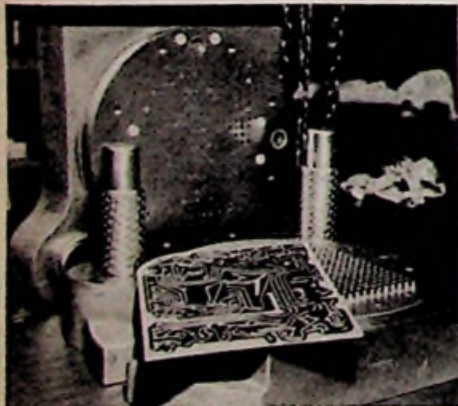
Die Grundplatte mit den galvanisch aufgetragenen Leitungszügen wird unter die Lochstanze geschoben
