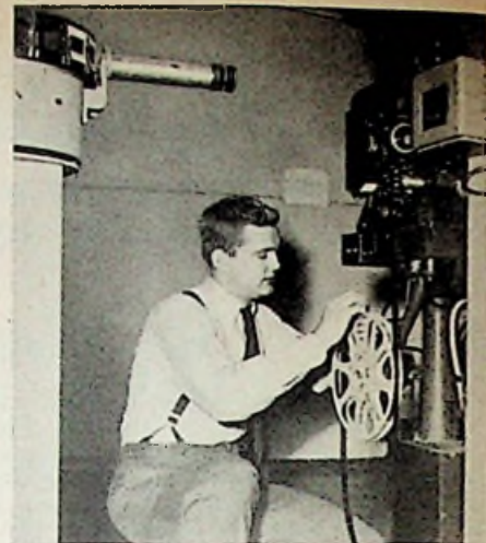
Bild 2. Einlegen eines 16-mm-Filmes in den Filmprojektor im Filmraum von AFR-TV. Der links sichtbare Dia-Abtaster wird ebenso wie der Filmabtaster vom Kontrollraum aus ferngesteuert
