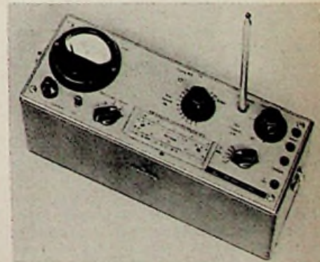
Bild 3. Das neue Transistor-Betriebsstörmeßgerät von Siemens & Halske
