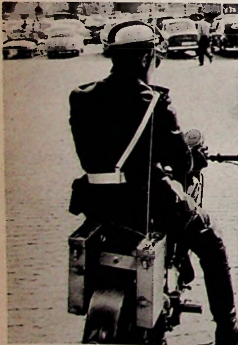
Bild 1. Telefunken-„Teleport“, eine kleine Funksprechanlage mit Mikrofon-Lautsprecher am Lenker für Motorräder
