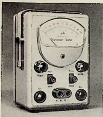
Bild 5. Der Transistor-Tester für Stromverstärkung und Kollektorreststrom von Gossen
